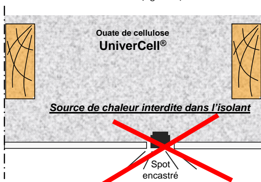
Figure 2 : Spot encastré non protégé interdit dans l'isolation
